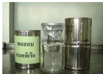
ภาพที่ 6 ขวดบรรจุตัวอย่างน้ำทางด้านแบคทีเรีย
