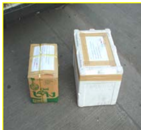
รูปที่ 17 กล่องโฟมสำหรับบรรจุและรักษาสภาพตัวอย่างน้ำส่งเข้าห้องปฏิบัติการ
