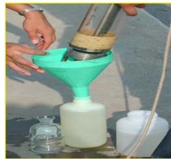
ภาพที่ 5 การบรรจุน้ำลงในขวดเก็บตัวอย่าง
