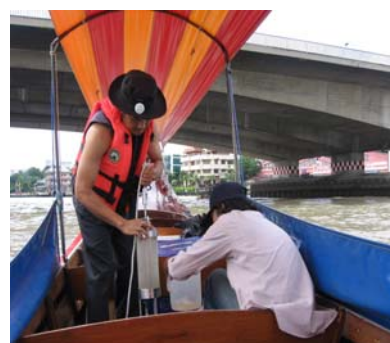
ภาพที่ 2 แสดงวิธีการเก็บตัวอย่างน้ำบนเรือ
