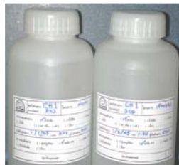
รูปที่ 14 ขวดบรรจุน้ำกลั่นเติมสารเคมีกรดไนตริก
