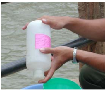
ภาพที่ 4 การกลั้วล้างขวดเก็บตัวอย่าง
