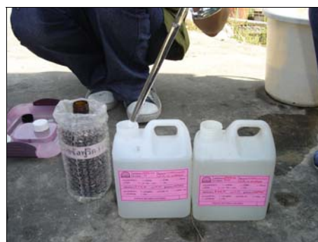
รูปที่ 3-7 แสดงการ Fix กรดซัลฟูริก 1:1 จำนวน 5 มิลลิลิตร สำหรับตัวอย่างไนโตรเจนในรูปที่เคเอ็น (TKN) และฟอสฟอรัสทั้งหมด (Total Phosphorus,TP)
