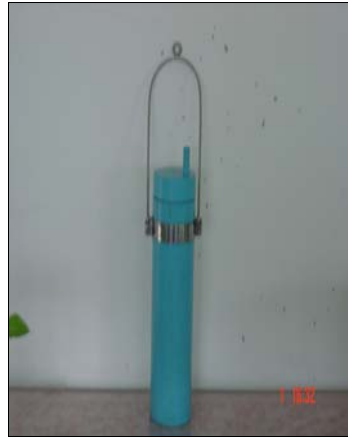
รูปที่ 2-3 แสดงเครื่องมือเก็บตัวอย่างน้ำ Water Sampler
