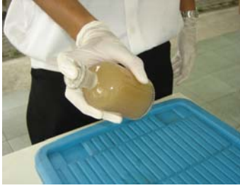
9. เขย่าขวดให้สารละลาย เข้ากันอย่างน้อย 15 ครั้ง
