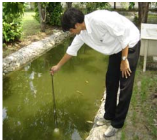
5. หย่อนขวดเก็บลงในแหล่งน้ำที่ความ ลึกประมาณ 50 – 100 เซนติเมตร (เก็บตัวอย่างน้ำจนไม่มีฟองอากาศ)
