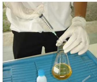
16. ไตเตรตจนสารละลายเป็นสีเหลืองอ่อน
