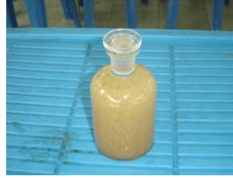
10. ตั้งขวดทิ้งไว้ให้สารละลาย ตกตะกอน อย่างน้อย 2/3 ส่วนของขวด
