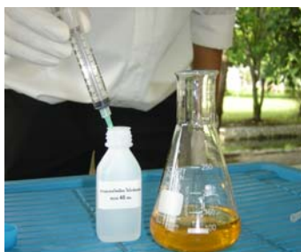
15. ใช้เข็มฉีดยาปิเปตต์สารละลายมาตรฐาน โซเดียม ไซโอซัลเฟต 10 มิลลิลิตร (ระวังอย่าให้มีฟองอากาศ)
